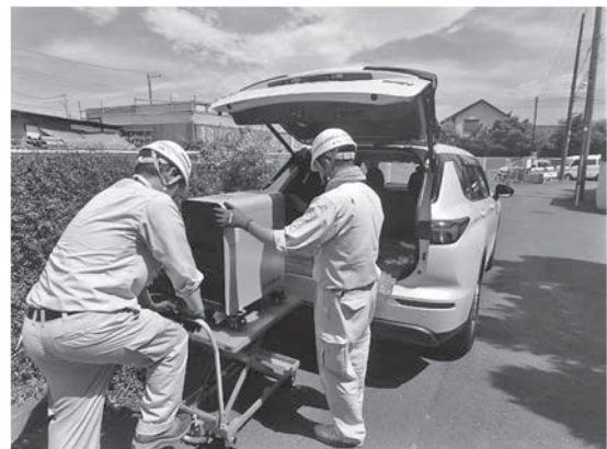
写真一1 PHEVへの可搬型蓄電池の積載作業の様子
