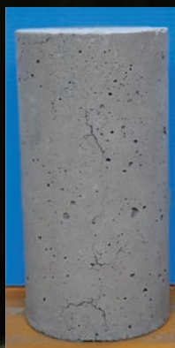
3体平均の 質量減少率3.4% (b) ジオポリマーコンクリート
