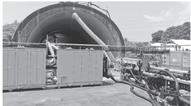
写真—2 実験全景（冷凍機（左手前）と模擬トンネル（奥））
