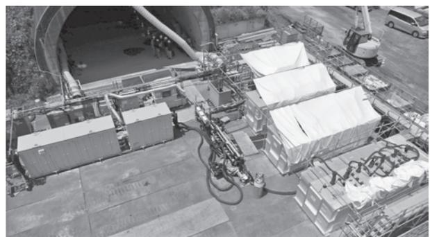
写真—3 実験全景（凍結プラント（左）実験土槽（右））
