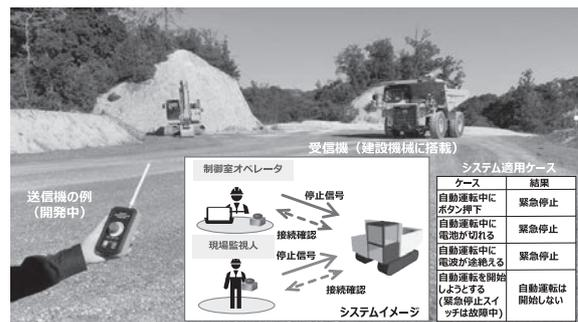
図一 無線緊急停止システム
