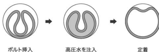
図—1 鋼管膨張型ロックボルト 1)
