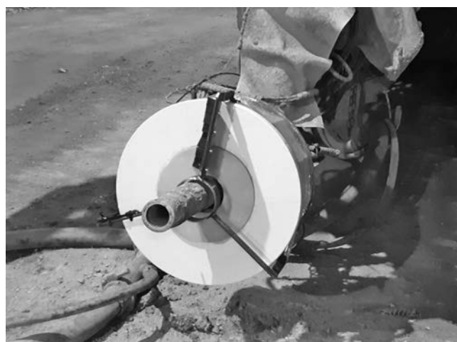
写真ー1 回転機構を有したレドーム
