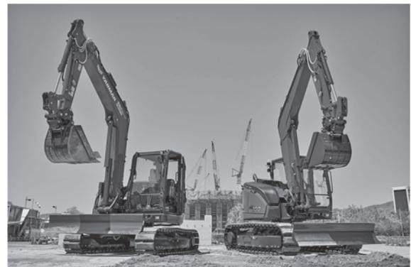
写真-1 (左) ヤンマー ViO80-7 後方小旋回油圧ショベル
