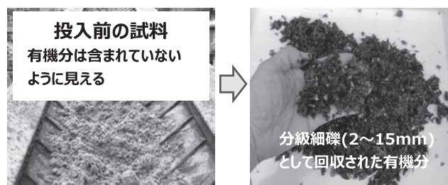
図—2 R4 年度実験での矢作ダム堆砂(左)と分級過程で抽出された有機分(右)
