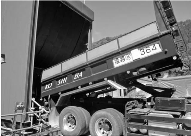
写真一五 すだれ状のゴム製カーテンによる騒音の漏れ防止
