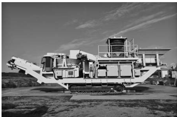
写真13 今回開発した自走型土質改良機 (TMSP1800)
