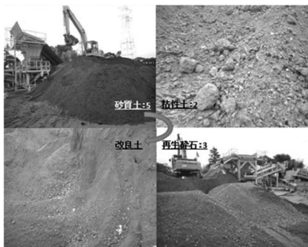
写真—11 原土（砂質土、粘性土、再生碎石）と改良土
