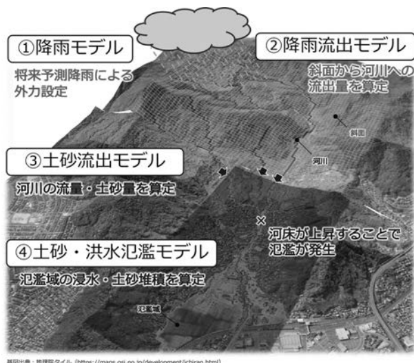
図－2 土砂・洪水氾濫のモデルの概要
