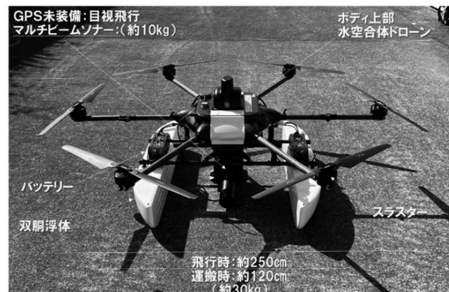
写真-2 マルチビーム搭載型ドローン初号機概要（初テスト時）
