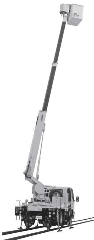
写真—1 アイチコーポレーション スカイマスター LK12C1FN 軌陸両用高所作業車
