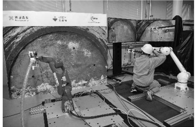
写真-1 装填ロボット
