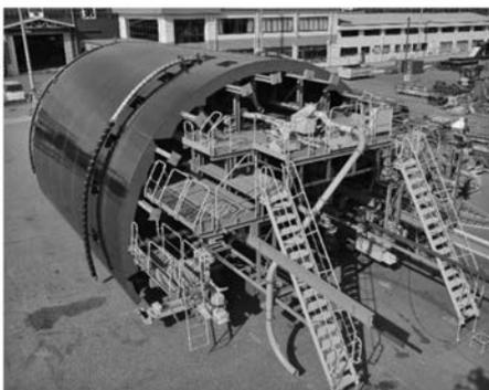
図-12 ホース伸縮式連続打設システムの概要および全景
