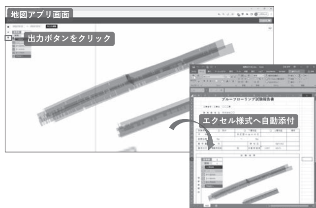
図—9 エクセル様式への試験結果自動添付機能
