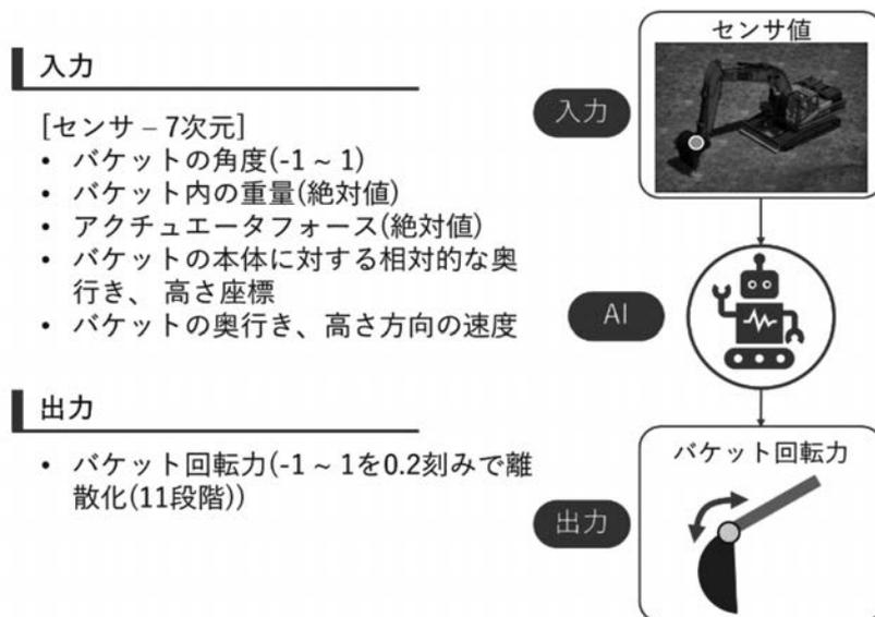
図-3 バックホウの掘削自動化におけるAIの入出力情報
