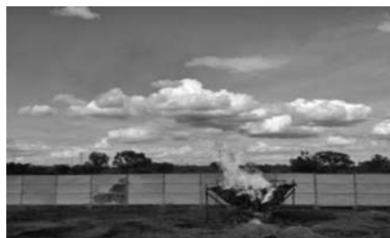
写真—3 圧縮空気(酸素)を噴射して焼却
