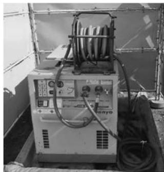
写真—4 コンプレッサー
