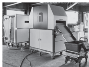
図—5 ノロ水脱水装置
