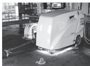
図—4 スラブ斜め切断カッター
