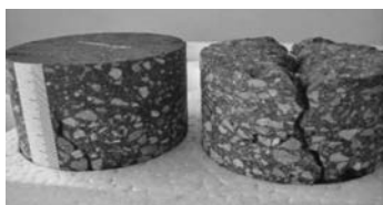
施工前のクラック（右）と 施工後にクラックが閉塞し ている状況（左）
