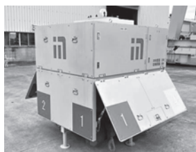
図—6 4点自動吊上げ装置
