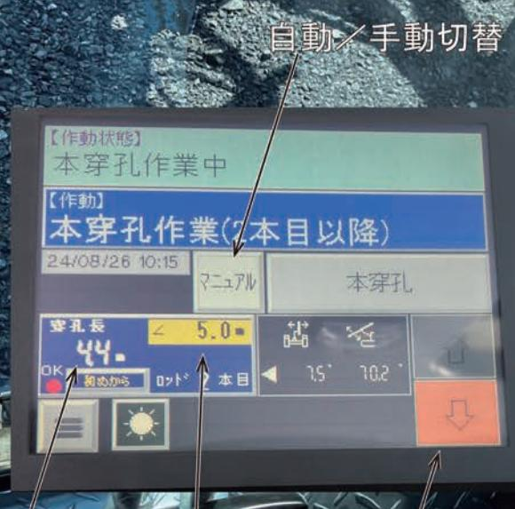
穿孔サポートシステムによるクローラドリル操作の簡素化
