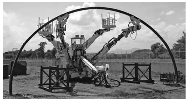
写真一 5 鋼製支保工建込みロボット
