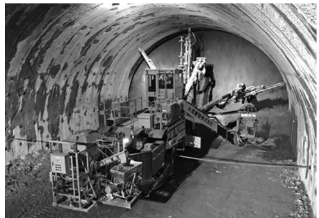
写真一 4 6m継ぎボルト打設装置を搭載したロックボルト専用ロボット「BOLTINGER」
