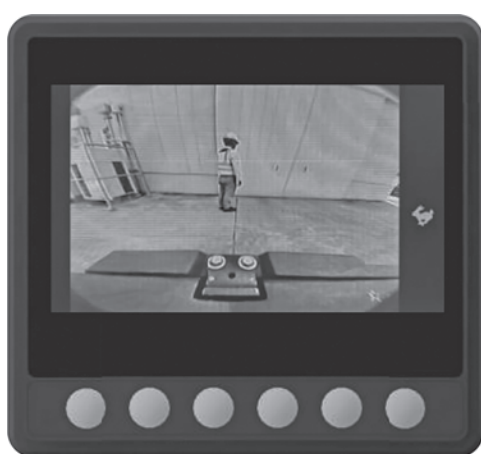
図—5 リアビューカメラ使用時のモニタ画面
