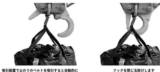
図—4 吸引装置使用方法
