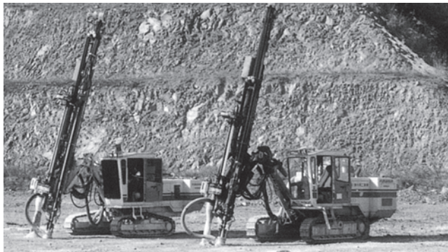
図-2 全自動クローラドリル(左側)と1マン2ドリル作業
