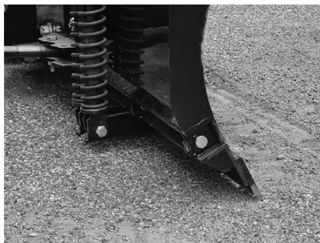
写真―11 障害物衝突時、エッジが跳ね上がる構造
