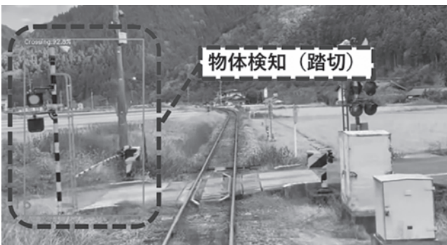
写真-3 物体検知の例 (踏切の場合)
