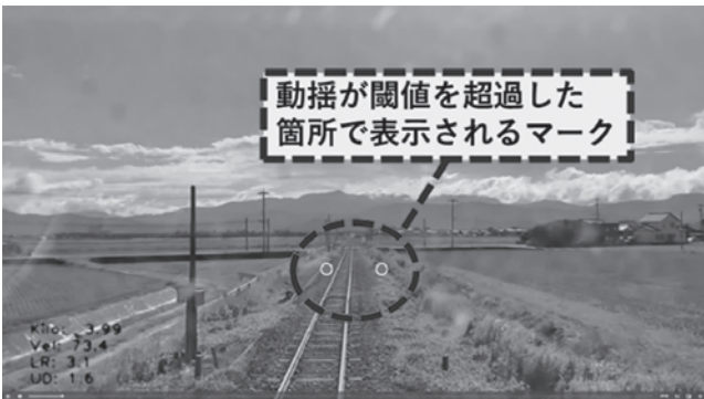
写真-2 動揺が閾値を超過した箇所のマーク表示
