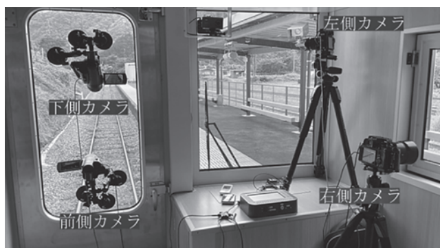
写真-2 列車内4方向カメラ設置状況
