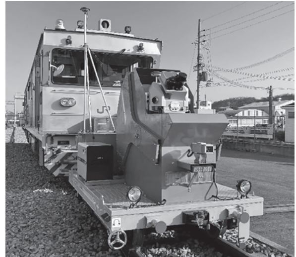
写真-1 鉄道MMS専用台車の外観
