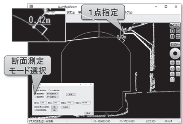
図一八 建築限界枠からの任意箇所離隔測定
