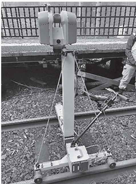
写真—4 手押し型レーザ計測装置
