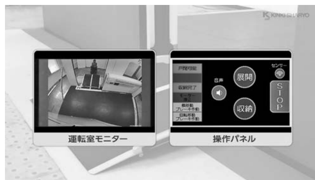
写真-1 運転室に設置するカメラモニターおよび操作パネル
