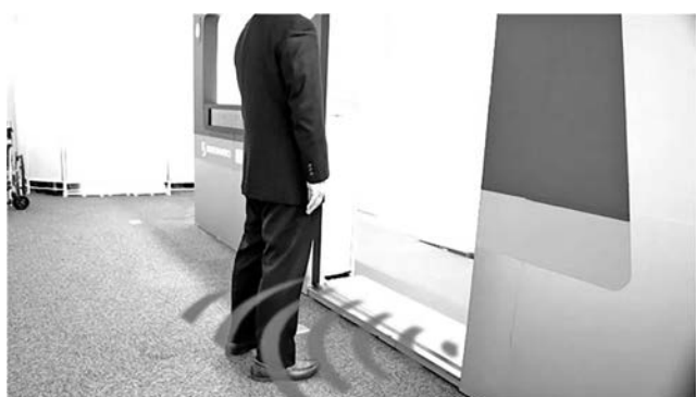
写真一 3 ホーム側 測域センサー検知範囲
