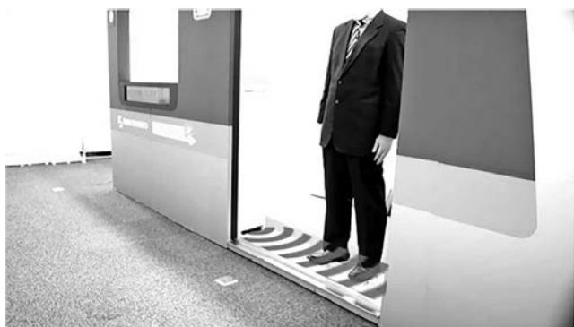
写真一 2 車両室内側 測域センサーおよび測距センサー検知範囲
