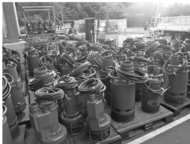
写真一八 整備済みの水中ポンプ
