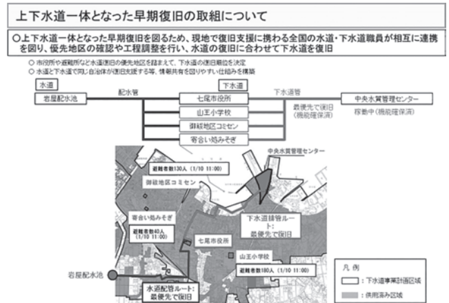
図-5 上下水道一体となった早期復旧の取組
