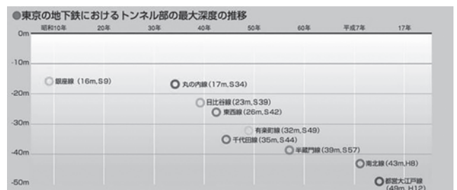
図-5 東京の地下鉄におけるトンネル部の最大深度の推移
