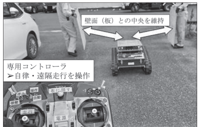
写真一 2 走行ユニット自律走行試験状況
