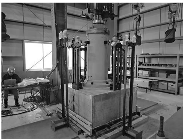
写真一2 実物大の荷重実験状況
