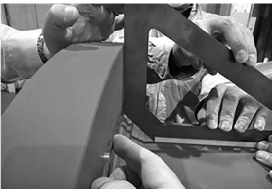
写真一三 管端の直角度測定状況
