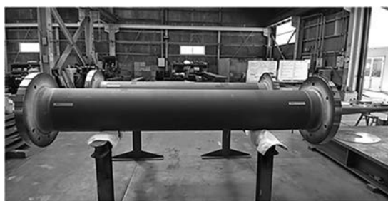
写真一 8 鋼管柱
