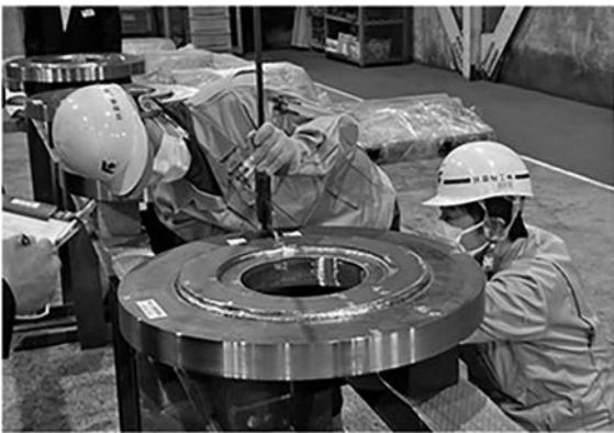
写真一一 支承板の厚さ測定状況
