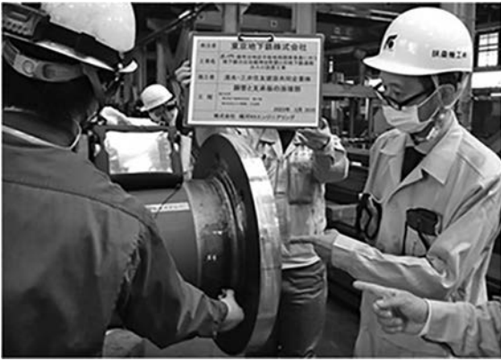
写真一〇 超音波探傷試験状況
