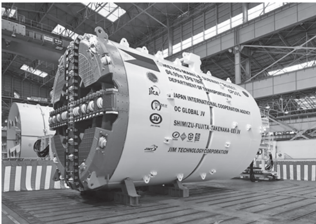
写真-4 土圧式シールドマシン(工場検査時)
