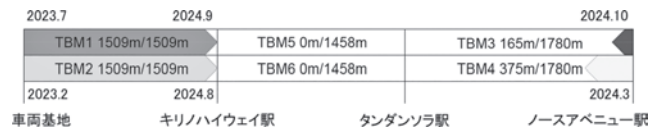
図-8 シールドマシン掘進進捗
