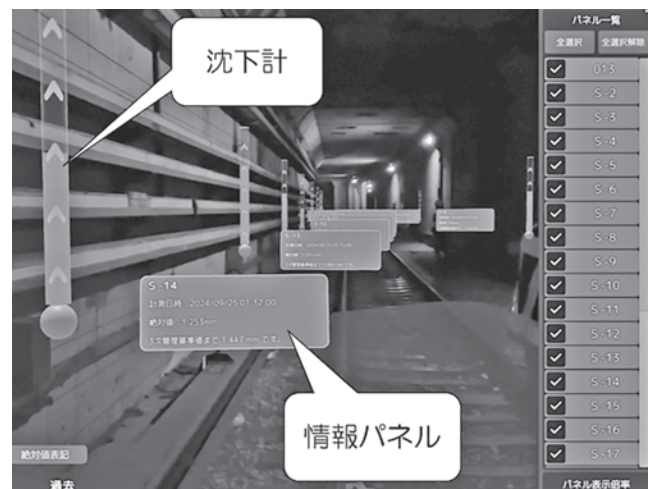
図-11 沈下計モデルの表示
