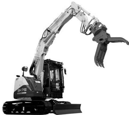
写真一 住友建機 SH75X-7 木造家屋解体仕様機 油圧ショベル
