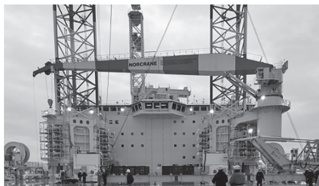
写真—2 30 トン吊 補助クレーン（Aux Crane）
