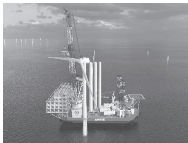
図-5 風車施工イメージ (エクステンデッドモード)
