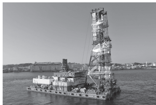
写真—3 環境配慮型深層混合処理船
