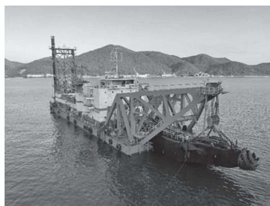
写真—1 ポンプ浚渫船
