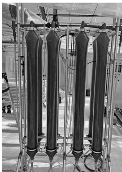
写真二 樹脂バッグ型藻類培養装置
