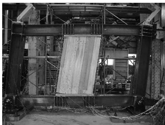
写真-2 構造実験 (CLT耐震パネル)
