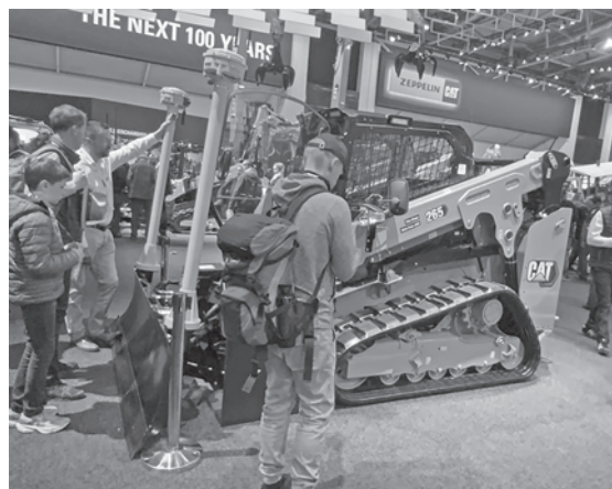
写真—24 スキッドステアローダに設置されたドーザのアタッチメント
