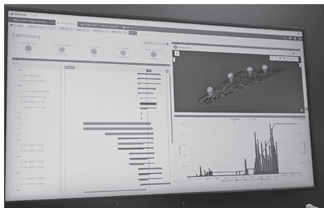
写真—28 建設機械の稼動履歴から得られる地形データによる工程管理システム（TOPCON）
