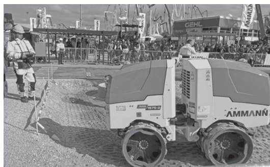
写真21 遠隔操作の小型ローラ (AMMANN のデモ)
