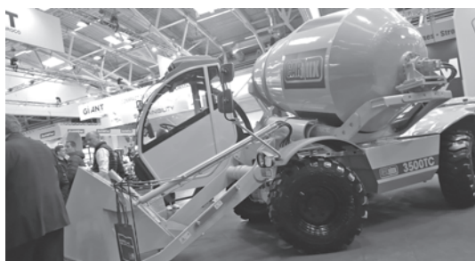
写真19 バケット付きミキサー車 (METALGALANTE)
