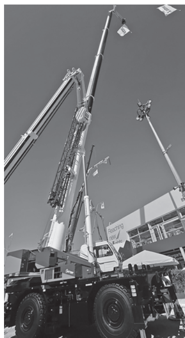
写真—14 電動式（100t吊り）ホイールクレーン（TADANO）
