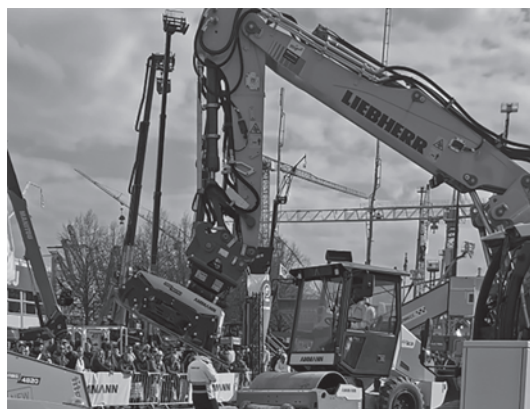
写真20 タンパのアタッチメントを付けたバックホウ (AMMANN のデモ)
