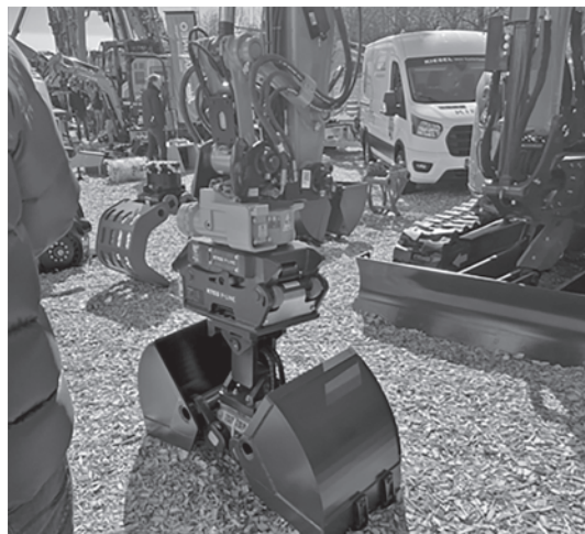
写真—22 油圧ショベルに設置された様々なアタッチメント
