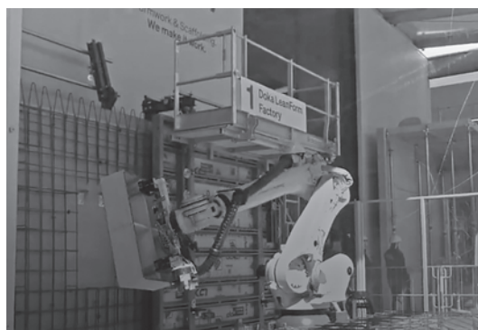
写真—31 鉄筋や窓枠を自動配置するロボットアーム (DOKA)
