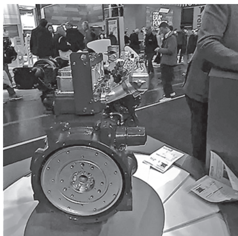
写真—33 発動発電機に搭載予定の水素燃焼エンジン (83 kW) (KUBOTA)
