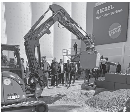
写真—12 マルチ回収装置を装着した油圧ショベル（HITACHI）
