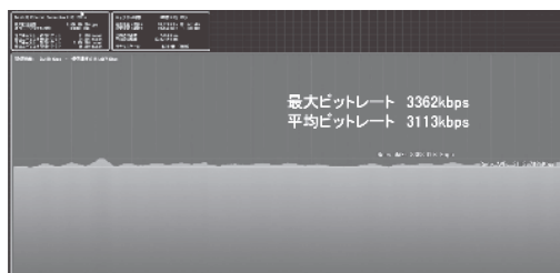
図—5 低軌道衛星回線による映像伝送特性
