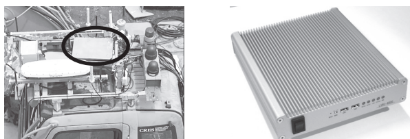
図-4 4ch HD エンコーダ (LVRC-4000)
