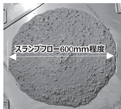
覆工用高流動コンクリート
