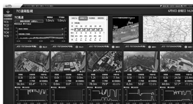
図一六 クレーン稼働状況可視化例
