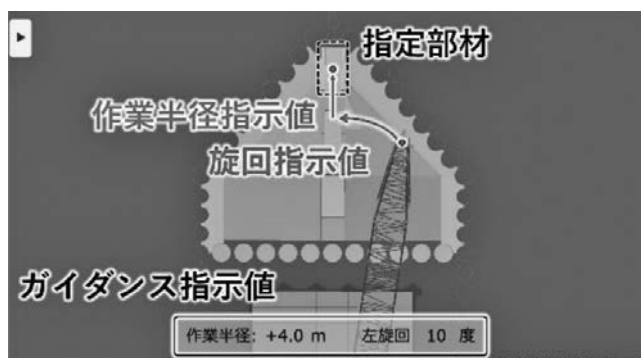
図一四 作業半径・旋回指示値表示
