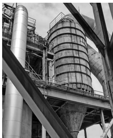
写真一 5 写真一 4 の左上方に見えているサスペンションプレヒーターの最上部
