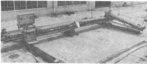
写真1 改良型コンクリート特殊打設機
