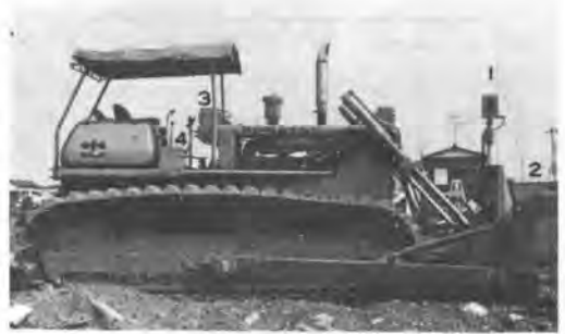
1. 受光器 2. 受光器駆動用シリンダ 3. 制御装置 4. 油圧ボックス
