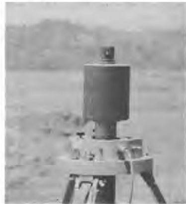
写真1. レーザ投光器主体
