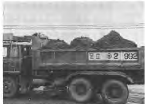
写真 遠心分離機からでたケーキのダンプ積載状態
