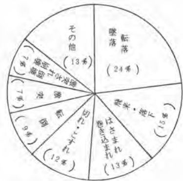
図-1 昭和51年度建設事業内で発生した事故の型
