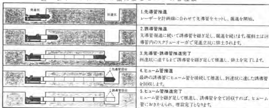
図-2.1 SMOLE機によるヒューム管埋設
