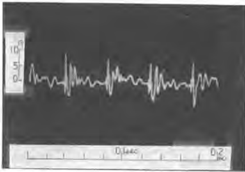
写真-2 ピックハンマの振動波形
